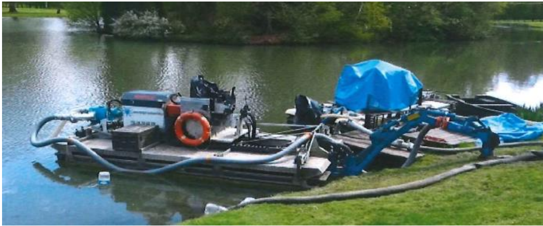
Figure 7 Dispositif similaire utilisé pour le faucardage
